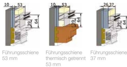
Führungsschiene 53 mm
