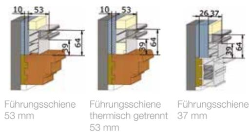
Führungsschiene 53 mm
