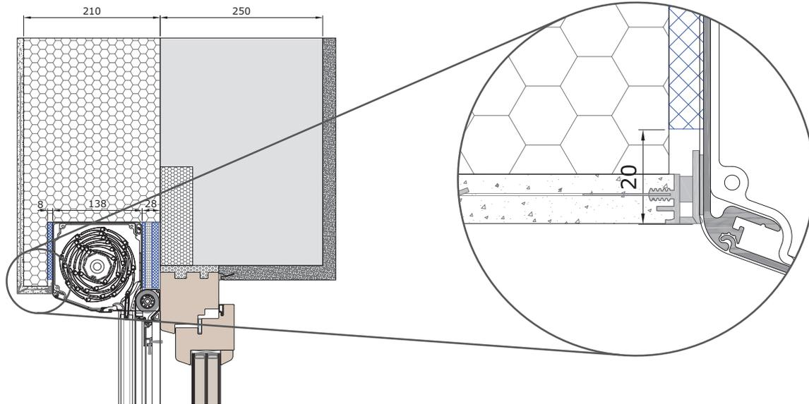
Mit Wärmedämmverbundsystem und Sturzdämmung. VORO WDVS mit kombiniertem Insektenschutz-Rollo.
