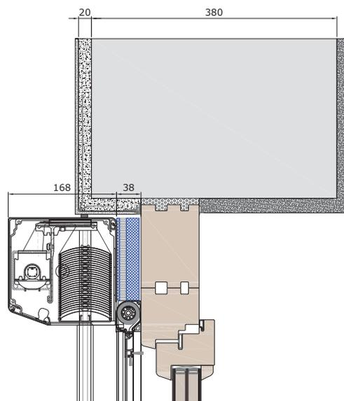
Mit Stockaufdoppelung und Sturzdämmung.
