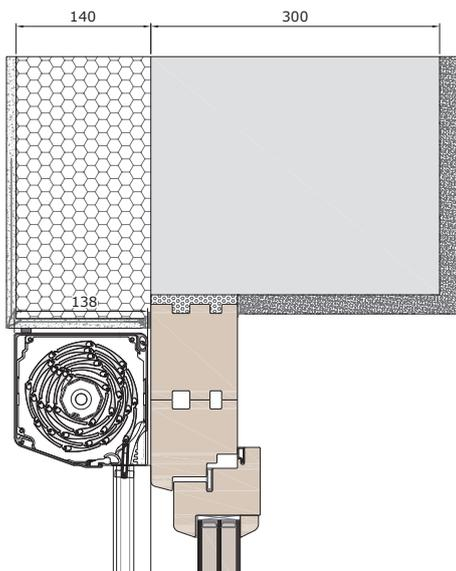
Mit Wärmedämmverbundsystem und Stockaufdoppelung.
